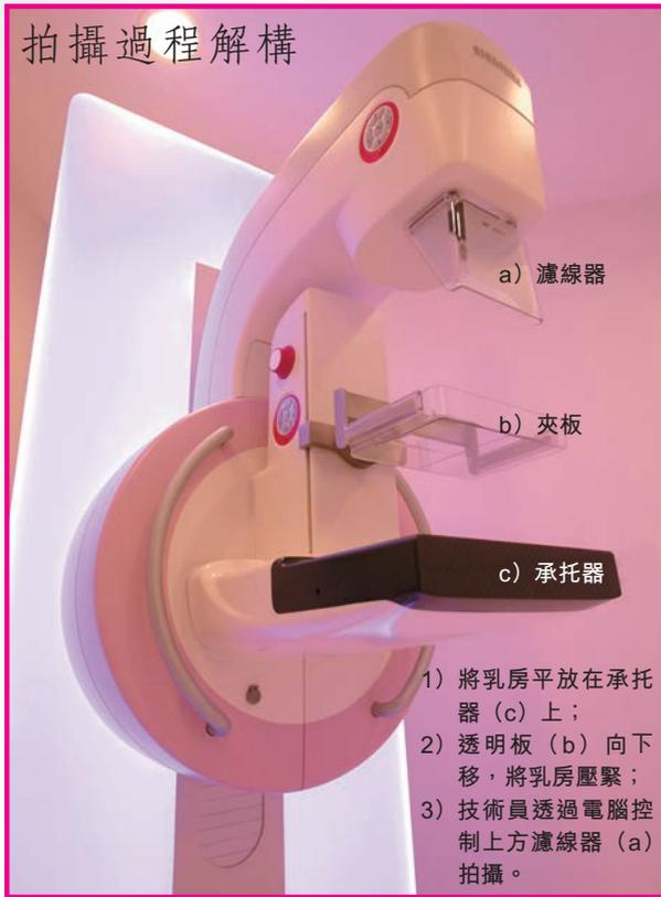
新式數碼化乳房X光造影儀，拍攝後的影像很快在電腦屏幕顯示出來。
